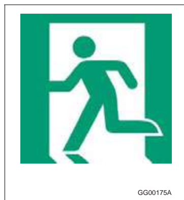
Figure A-3.4.5.1. 2)c)-A « Issue de secours à gauche » (E001), symbole extrait de la norme ISO 7010
